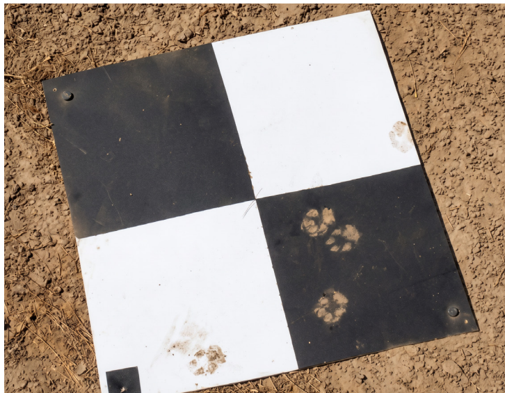
Exemples de marqueurs temporaires au sol qui seront déployés pendant les relevés par drone.
