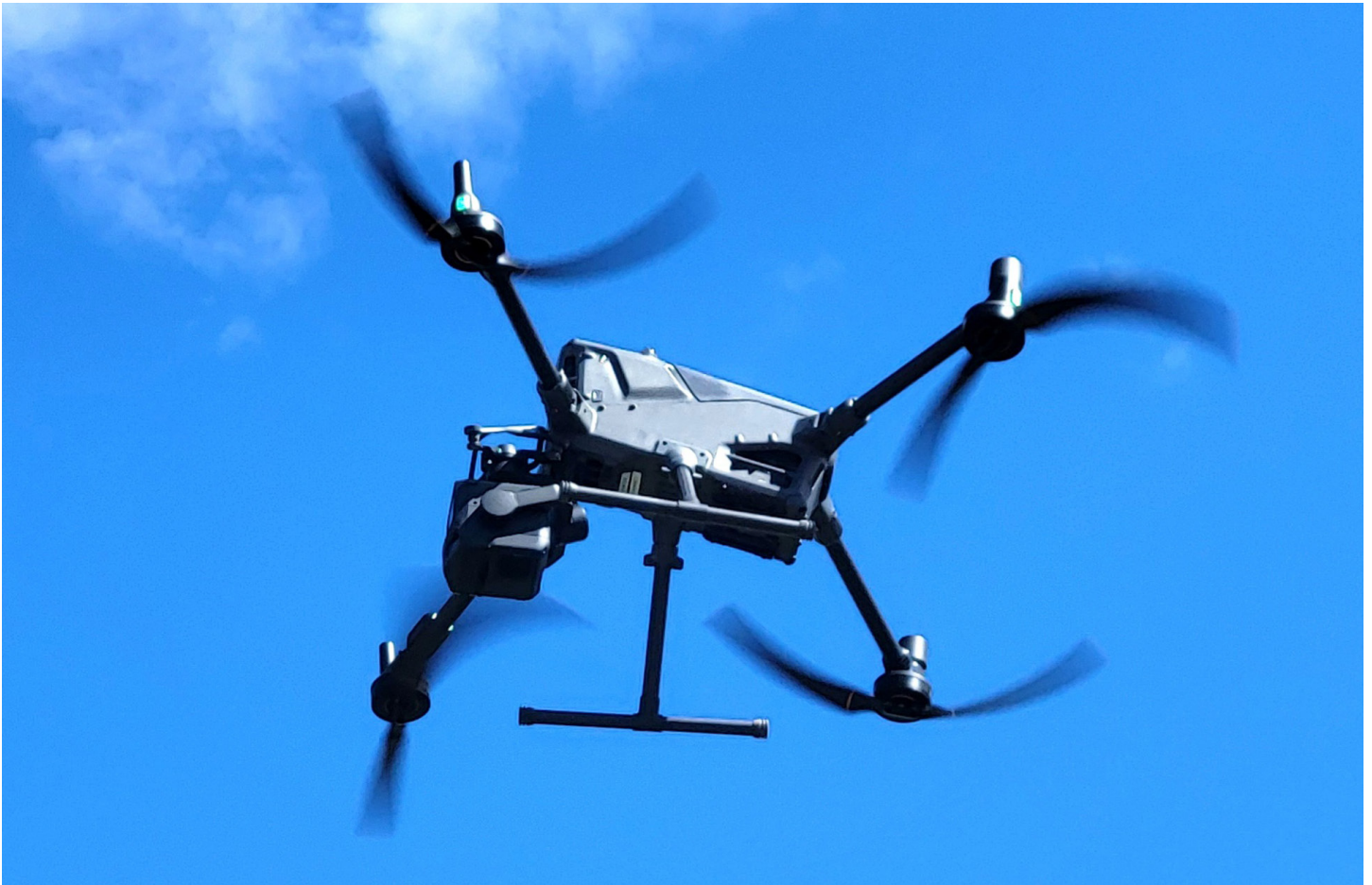
Drone équipé d'un appareil LiDAR et d'une caméra de haute résolution pour les relevés.
